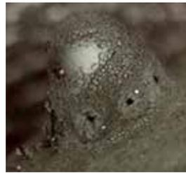
Orifices d'injection encrassés avant le nettoyage.
